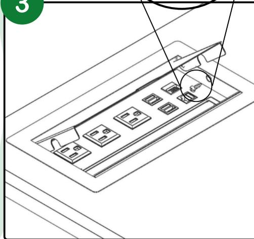
Una vez montado el producto, fija el modelo al mueble por medio de los barrenos que este tiene a los costados con las pijas ya incluidas en la caja.
