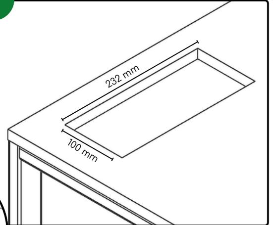
Su montaje requiere de un orificio de 232 x 100 mm.
