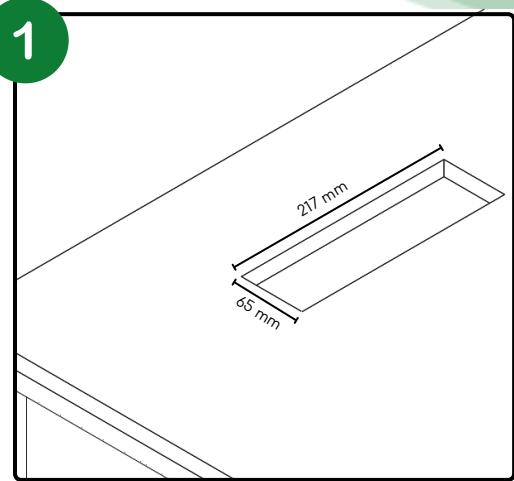
Su montaje requiere de un orificio de 217 x 65 mm.
