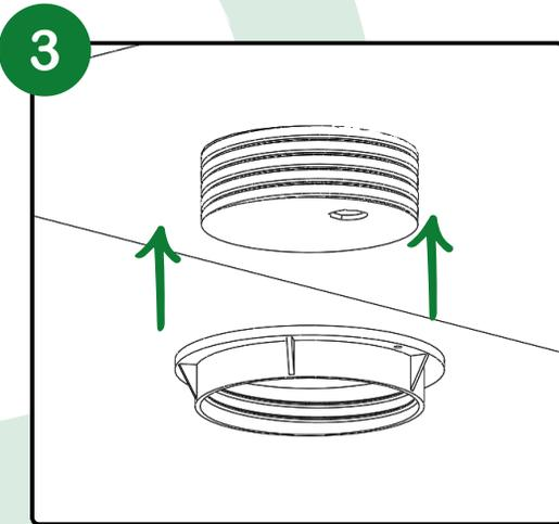
Coloca la tuerca por debajo del multicontacto. Procede a girarla al contrario de las manecillas del reloj de tal forma en la que quede completamente asegurado y ajustado a la superficie.
