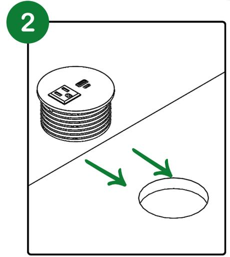
Coloca el modelo dentro el orificio.
