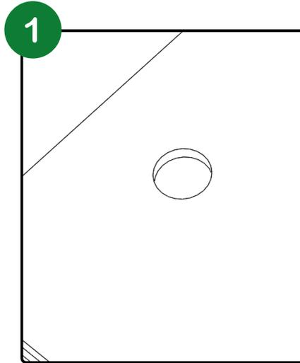
Su montaje requiere de un orificio de 86 mm (3 - 3/8") de diámetro.
