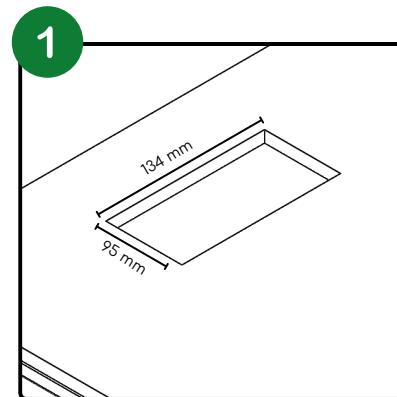
Su montaje requiere de un orificio de 134 x 95 mm.
