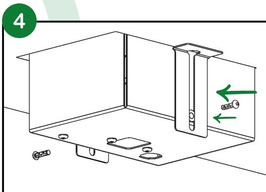
Una vez ajustadas las escuadras proceder a colocar los tornillos incluidos en la caja, ajustar y apretar los tornillos para mejor fijación al mueble.
