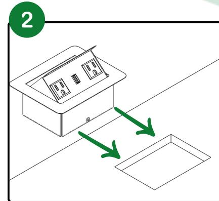
Coloca el modelo dentro el orificio.
