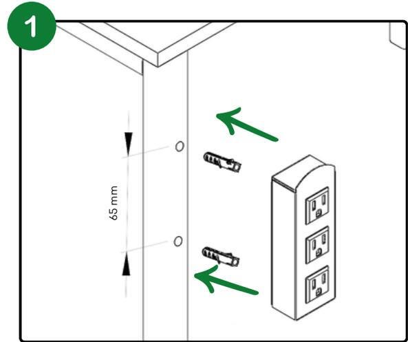
Realiza dos barrenos de 1/4" con 65mm entre los centros de estos, posterior a esto se debe de colocar un taquete en cada orificio
