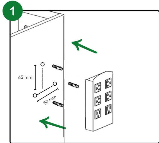
Realiza dos barrenos de 1/4" con 65mm entre los centros de estos, posterior a esto se debe de colocar un taquete en cada orificio
