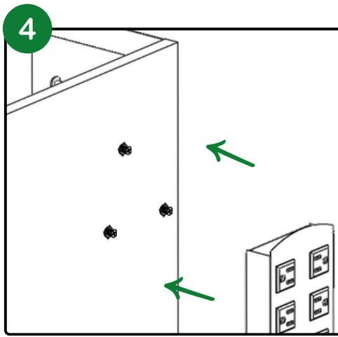
Para finalizar inserta el multicontacto de manera en el que las perforaciones que este tiene embone en las pijas.
