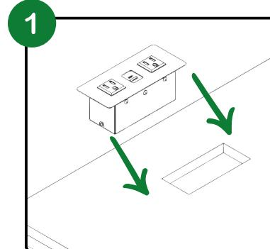
Su montaje requiere de un orificio de 120 x 53 mm.
